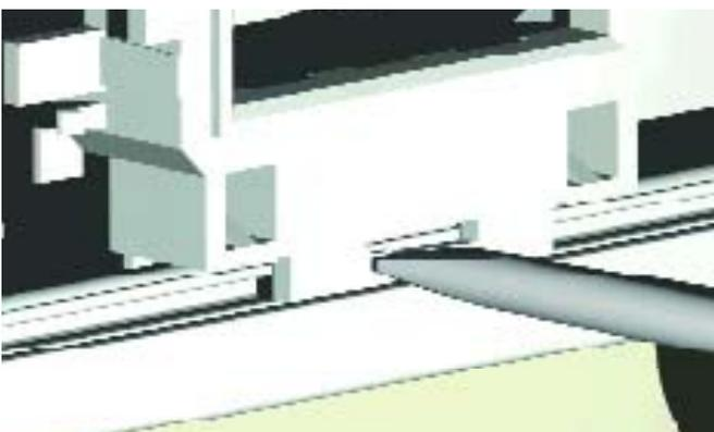
После установки суппорта на основание короба необходимо отверткой вдавить фиксатор.
